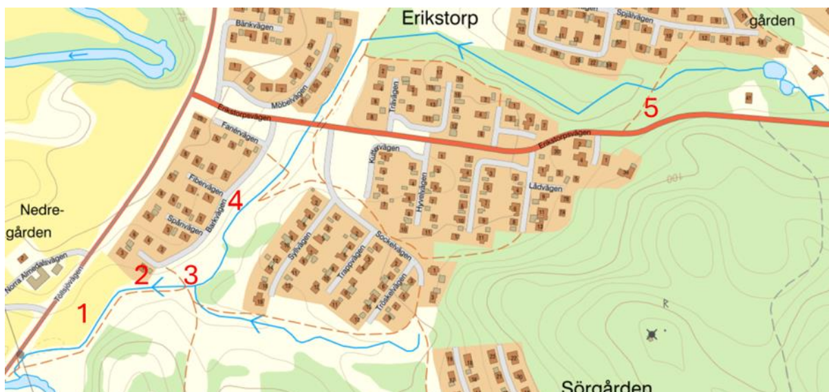
Platser som behöver förbättras (siffror). 1,3 och 5-Vägtrummor som är vandringshinder, 2-sprängsten, 4-solbelyst sträcka där man kan plantera buskar/träd.
